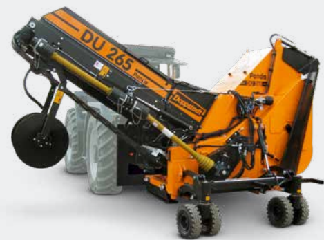
DU 265 Der flexible gezogene Anbaumsetzer für den Tafelmietenaufbau auch in niedrigen Lagerhallen.
