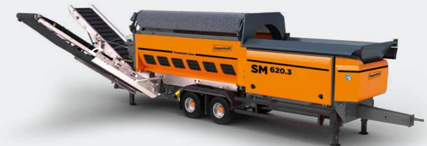
SM 620.3 Siebfläche: 30,2 m 2 Bunkervolumen: 5 m 3 Gewicht: 19.000 kg
