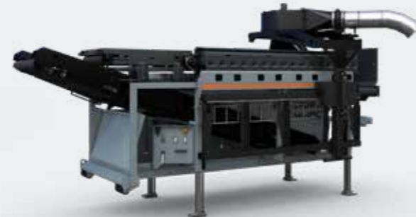
SELECTOR 400 MIT WINDSICHTERANBAU Im gleichen Arbeitsgang können Sie zusätzlich eine Leichtfraktion separieren.
