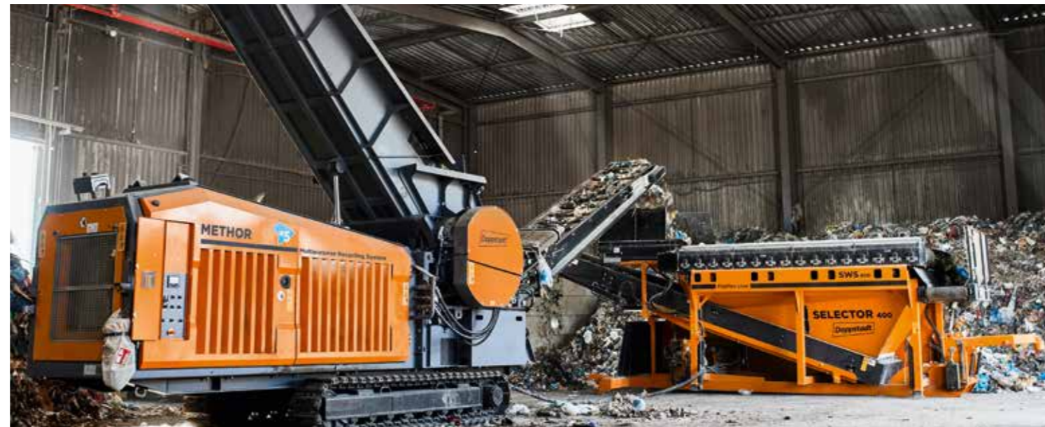
SELECTOR 400 MIT WINDSICHTERANBAU Im gleichen Arbeitsgang können Sie zusätzlich eine Leichtfraktion separieren.
